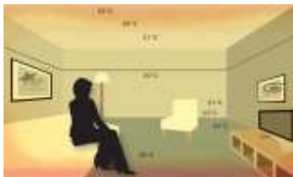
Распределение тепла при использовании системы обогрева пола. Небольшой разброс температур (20–25°C) в помещении: теплей всего именно там, где нужно!
